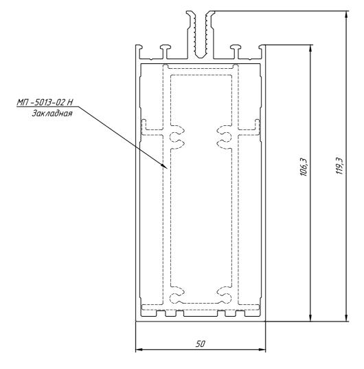
Крепление закладной МП-5013-02Н к верхнему/нижнему перекрытиям при монтаже в проем,осуществляется через монтажную пластину МПС-01-001.
